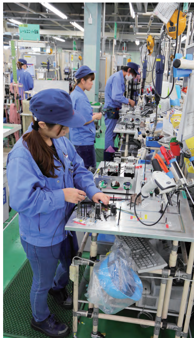
◀ハーネス組み立てからサブ組み立て、メイン組み立て、検査・試験を重ねて制御盤はつくられる。
