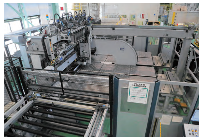
▲「かご室」などの意匠品づくりでは、工作機械による自動化が進んでいる。
