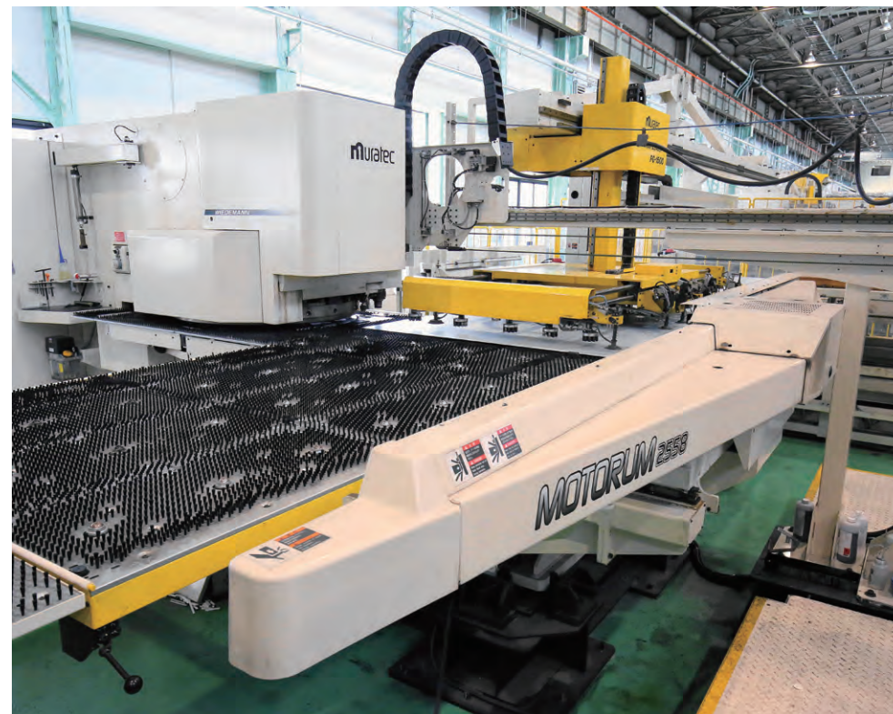
▲鋼板をパンチプレス機で打ち抜き加工する。
