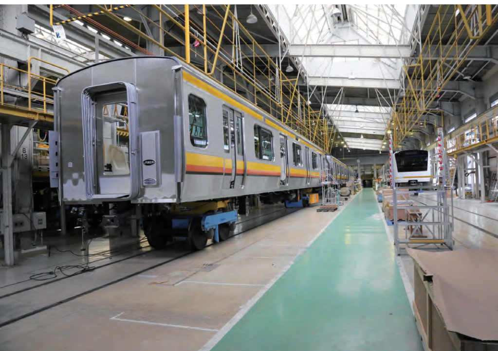
▲車両は台車と合体し、最終検査を行う。
