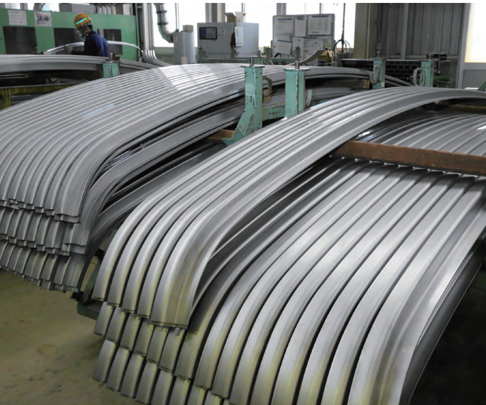
▲ステンレスは切断や曲げ加工などが施され、車両の各部分に活用される。
