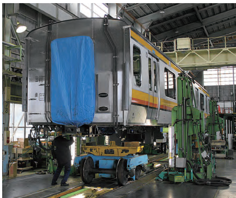
◀別々の工程で出来上がった車体と台車をドッキングさせる。
