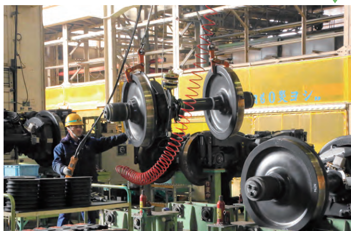
▲巨大な台車の溶接。「鉄の塊」にさまざまな部品が取り付けられていく。 ▶台車に車輪が組み込まれる。
