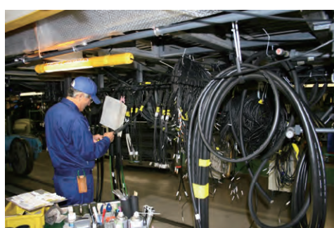
▲車内にケーブルなどを敷設していく。 ◀ここでも高い技能を持った職人技が生かされている。
