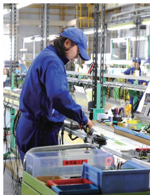
◀車内に敷設されるケーブルを組み立て・チェックする。
