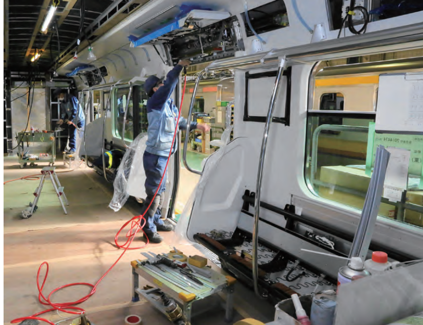
▲車内にケーブルなどを敷設していく。 ◀ここでも高い技能を持った職人技が生かされている。
