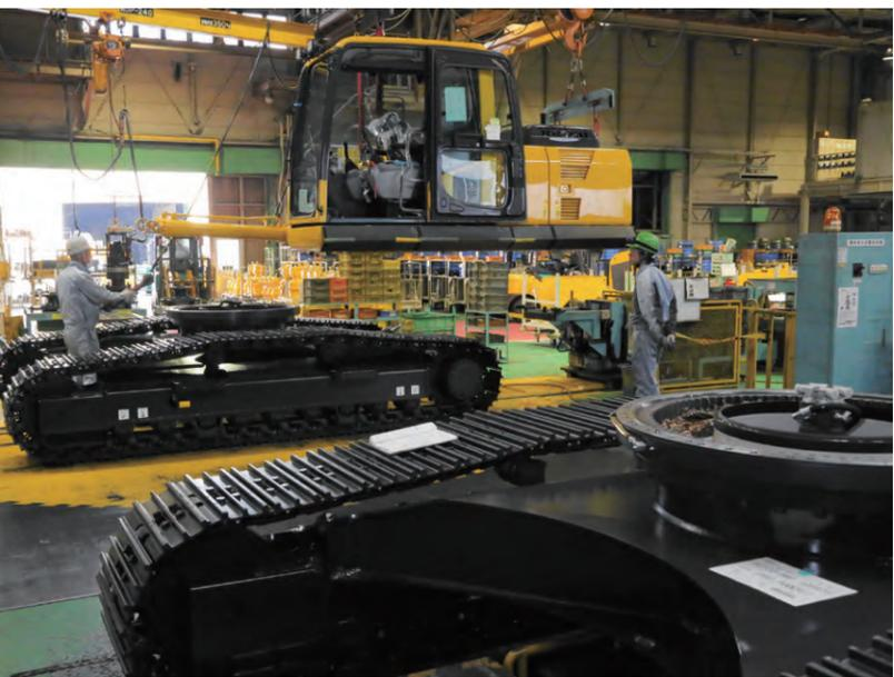
▲メインライン工程ではレボフレームとトラックフレームを合体させる。
