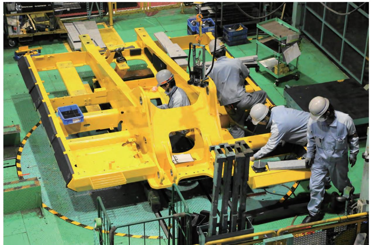
▲上部旋回体のボディとなる「レボフレーム」。ここから油圧ショベルの製造が始まる。
