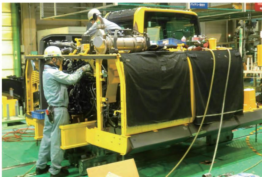
▲レボフレーム組立工程は、熟達した作業員が慎重に作業を進める。
