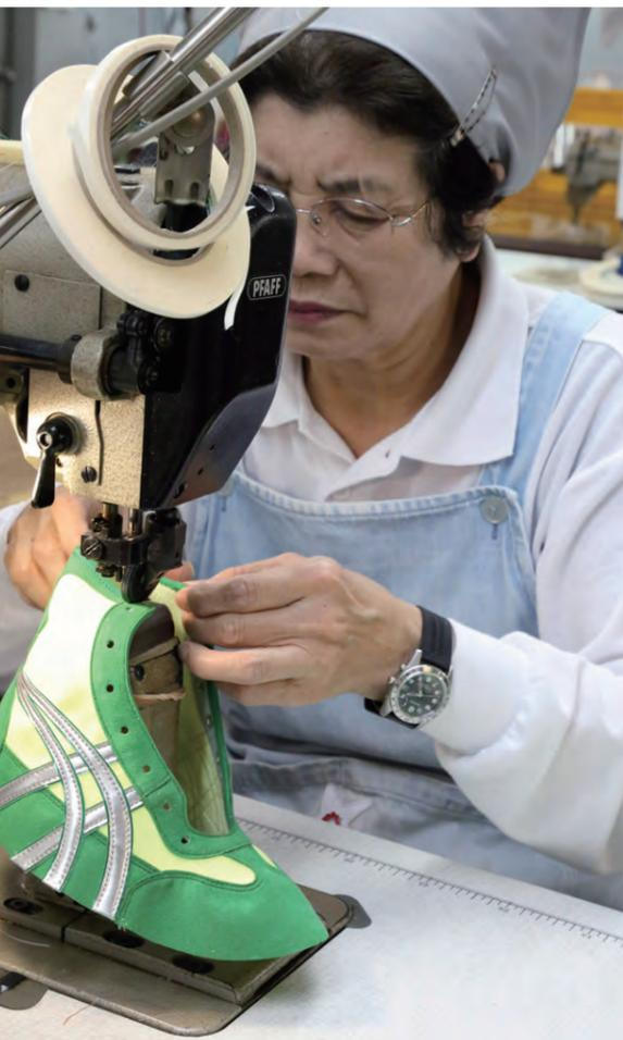
▲裁断された革を縫製し、アッパーをつくり上げていく。（写真はレスリングシューズの縫製模様）
