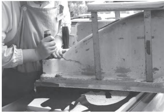
▲抜き型を用いて、プレス機で革を裁断する。
