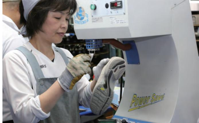
▲靴に熱風を吹きかけ、表面のしわを取る。
