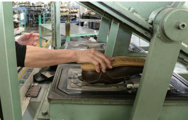
▲真空圧着機で完全にアップパーとソールを結合させる。
