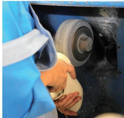
◀バフ掛けは手作業だけでなく、機械を用い、表面をきれいに仕上げておく。
