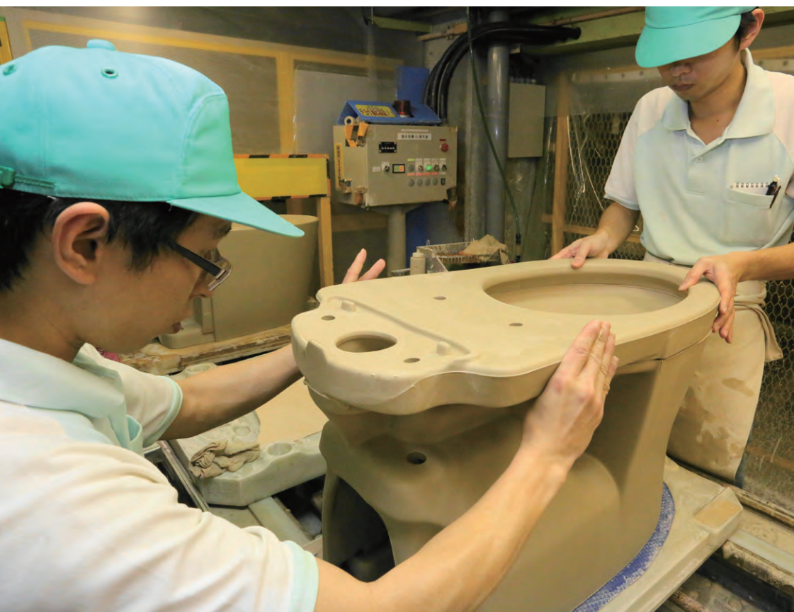
▲便器の上のリム部と下の胴の部分を手作業で合体。微かなズレも許されない工程だ。
