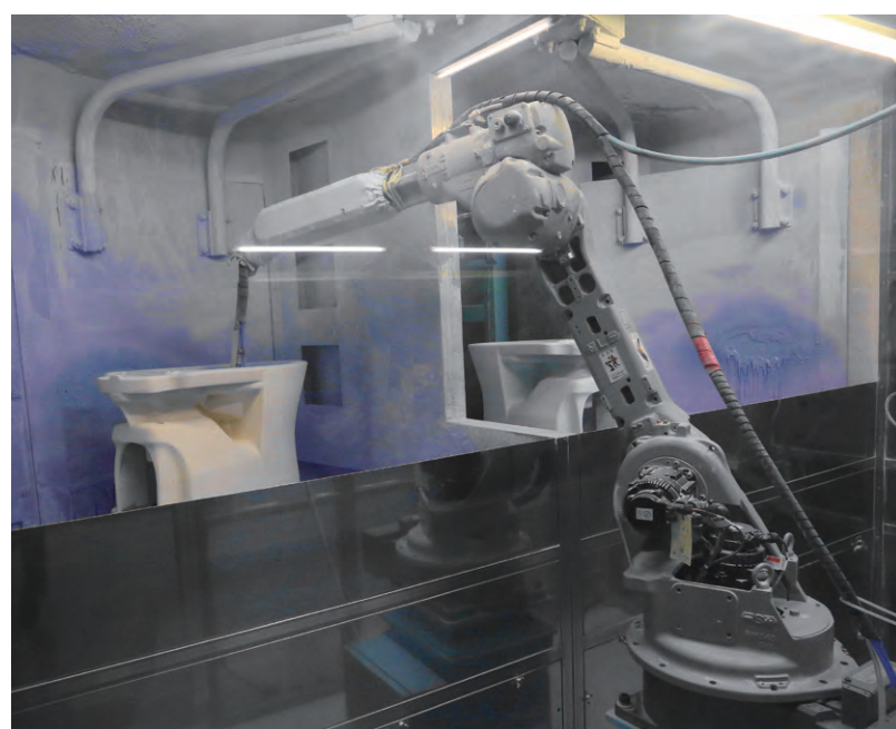
◀TOTOが独自に開発した「セフィオンテクト」の塗布工程。
