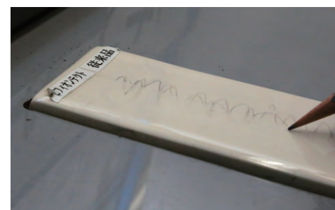
▲表面処理技術でツルツルになり、鉛筆の黒鉛が付きにくい。（左・セフィオンテクト、右・従来品）
