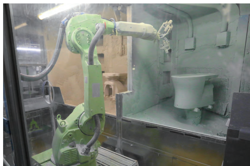
▲ロボットにより釉薬を吹き付けられる便器。
