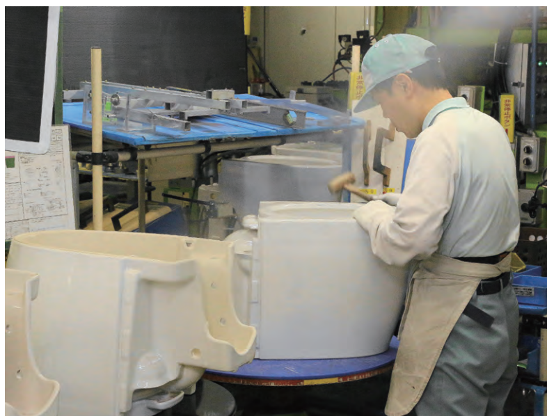
▲木製のハンマーで叩いた音で、ひび割れの有無を厳重にチェック。
