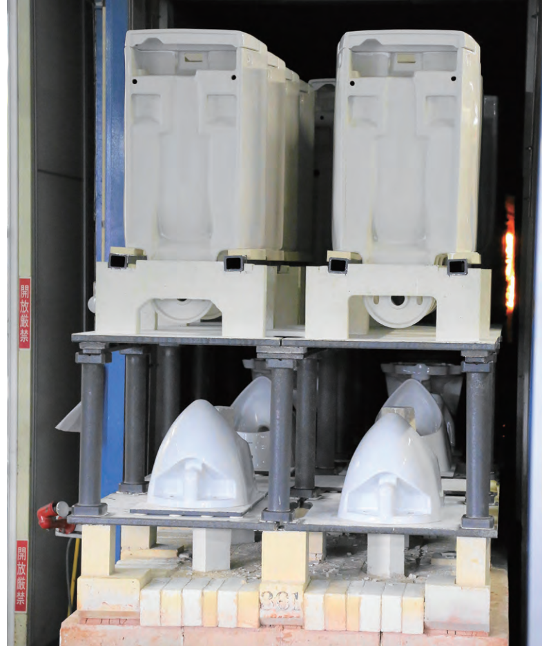
▲焼成工程を待つ衛生陶器。巨大なトンネル窯で丸一日かけて焼かれる。
