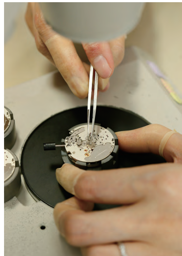
▲270の微細な部品をひとつずつ、ピンセットを用いて取り付けしていく。
