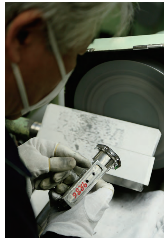
▲セイコーエプソン独特のザラツ研磨。曲面や平面を磨き上げる高級仕上げ技法だ。
