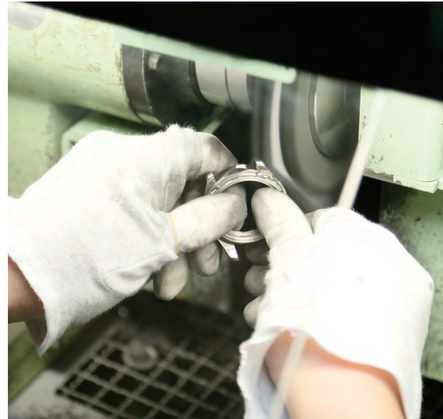
▲ケースの表面を磨く。職人の経験と感覚が試される工程だ。
