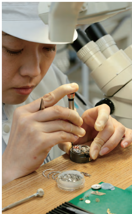
▲25℃に設定された室内で、一人の職人がひとつのムーブメントの組み立てに責任を持つ。
