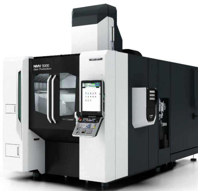
JIMTOF 2024にて世界初出展 5軸加工機に歯車研削ユニットを搭載し、
