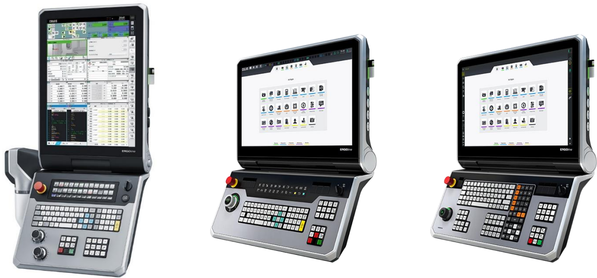
ERGOline X with CELOS X ※左から順に MAPPS, SIEMENS, HEIDENHAIN
