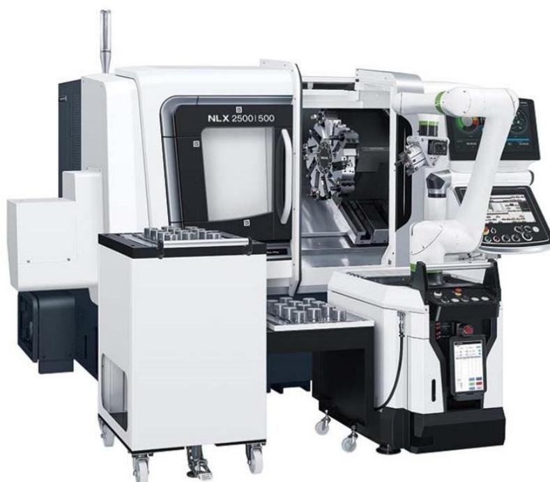
ターニングセンタとロボットシステム「MATRIS Light」を組み合わせた自動化
