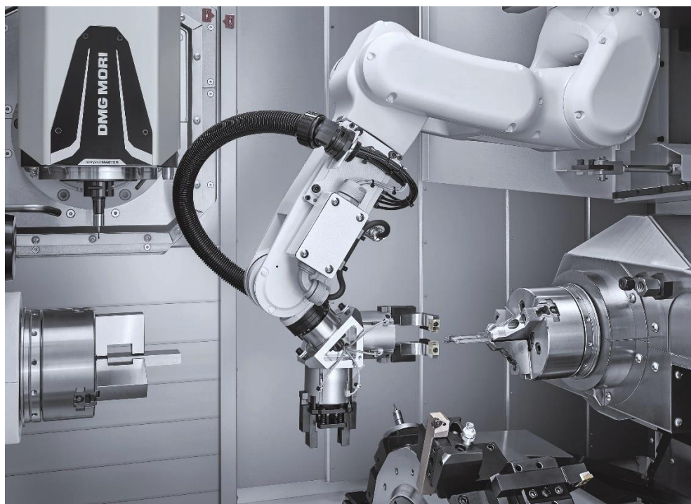
機内走行式ロボット IMTR によるワーク自動脱着
