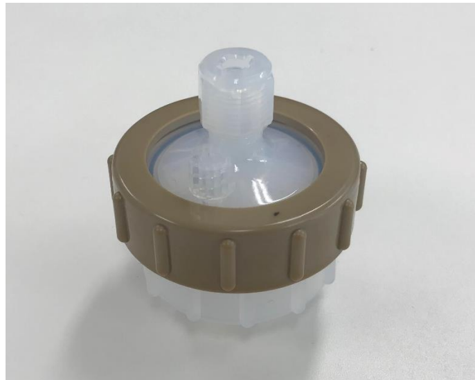
DMG MORI Global One 号に搭載された マイクロプラスチック採集用のフィルター
