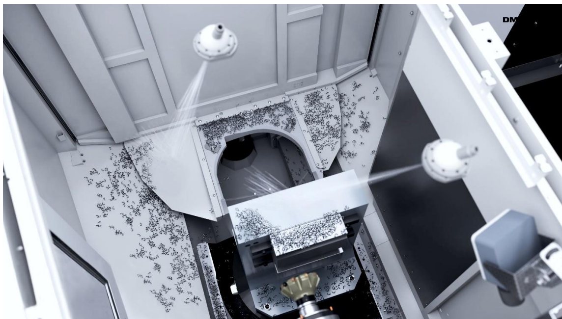
クーラントノズルによる切りくず除去の様子
