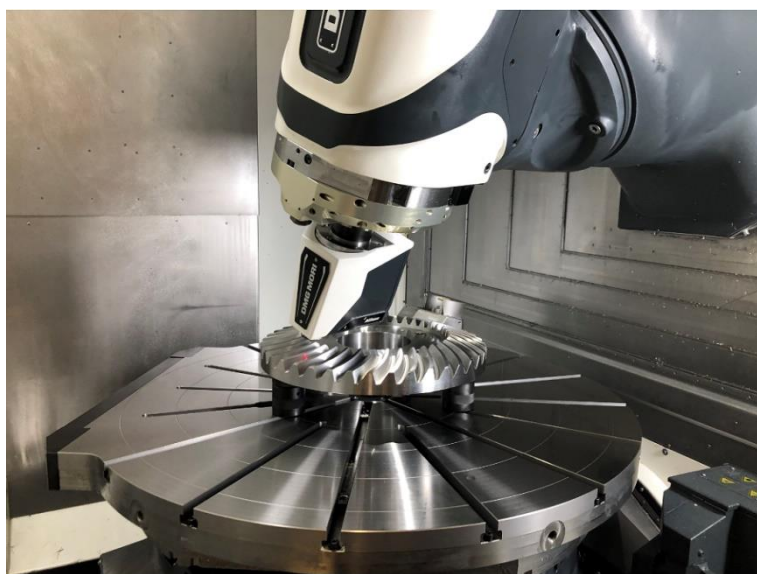
ニコンの非接触レーザースキャナー「LC15Dx」搭載イメージ
