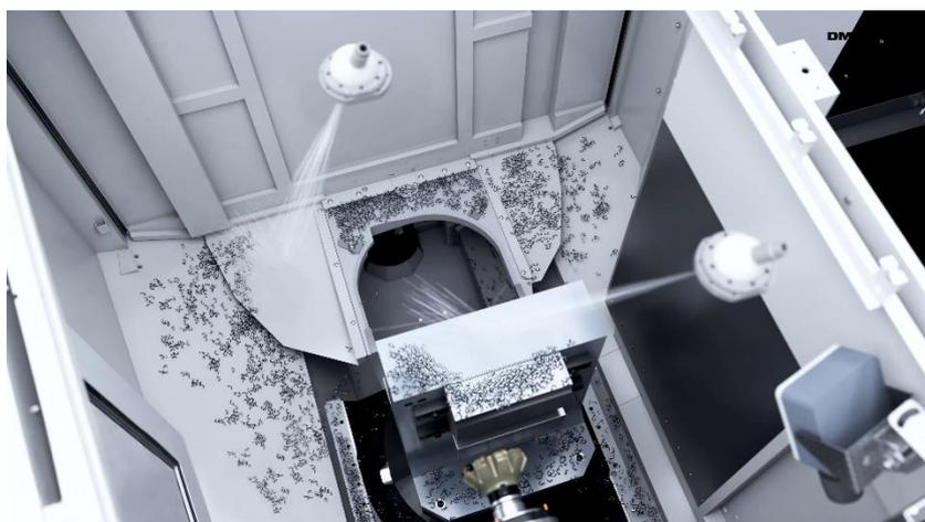
AI 切くず除去ソリューション\_自動洗浄ノズル
