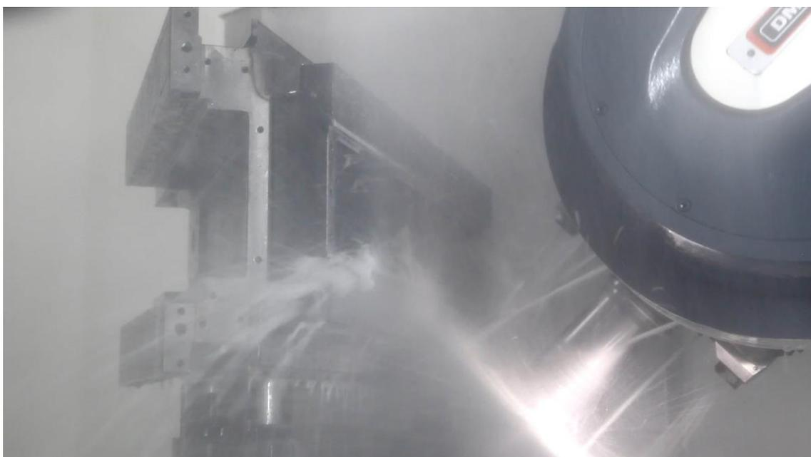
セラミック砥石による研削加工
