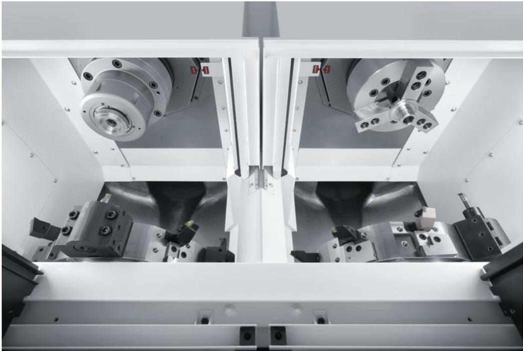
写真 2. ビルトイン主轴と刃物台
