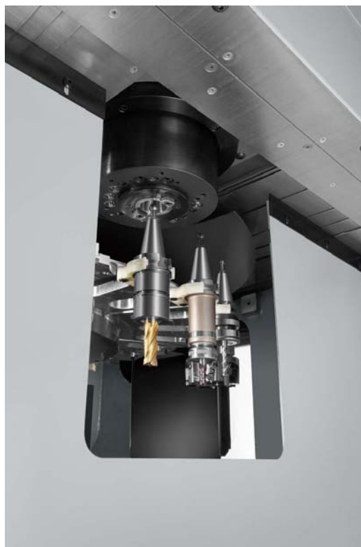
写真 4. シンプルなアームレス方式を採用した ATC
