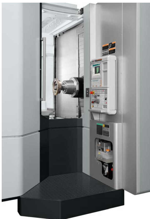
図 4. 機内への接近性が向上した作業エリア
