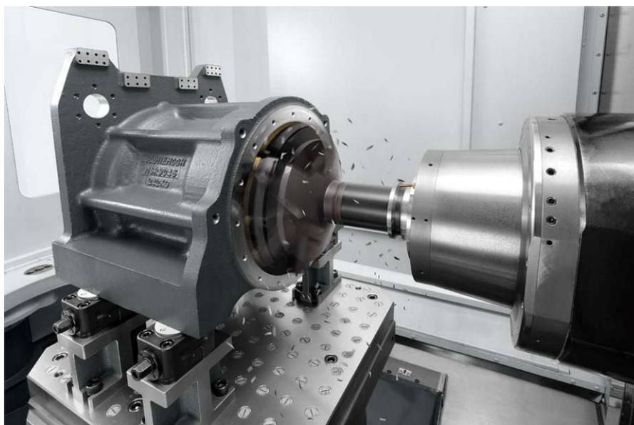
写真 12. φ300 mm ボーリングカッターでのギヤハウジングの加工
