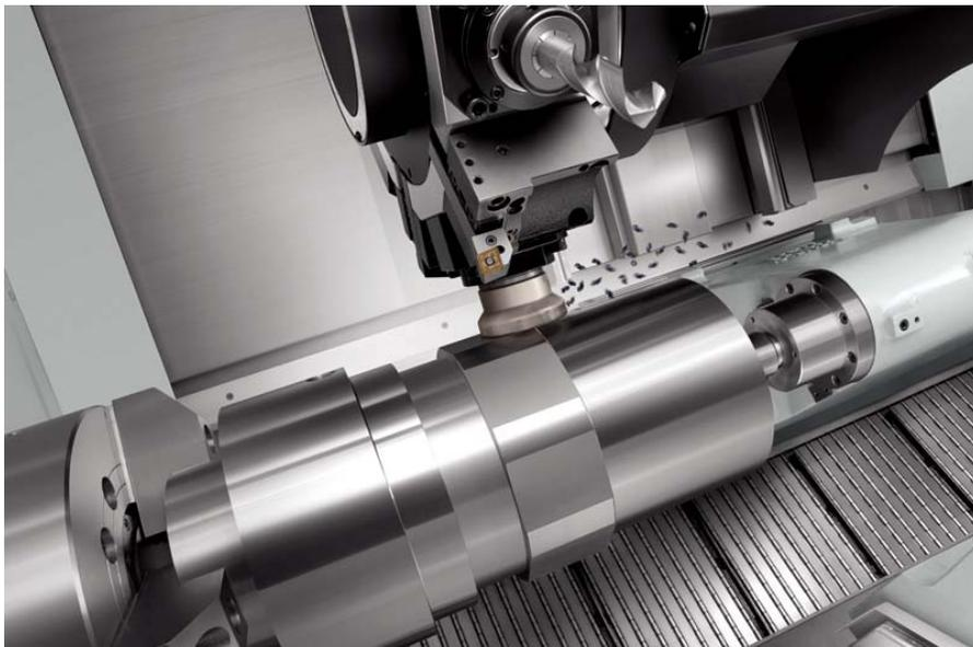
写真 10. 高トルク回転工具主軸での重切削
