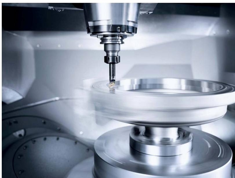
写真 6. FD 仕様での旋削加工
