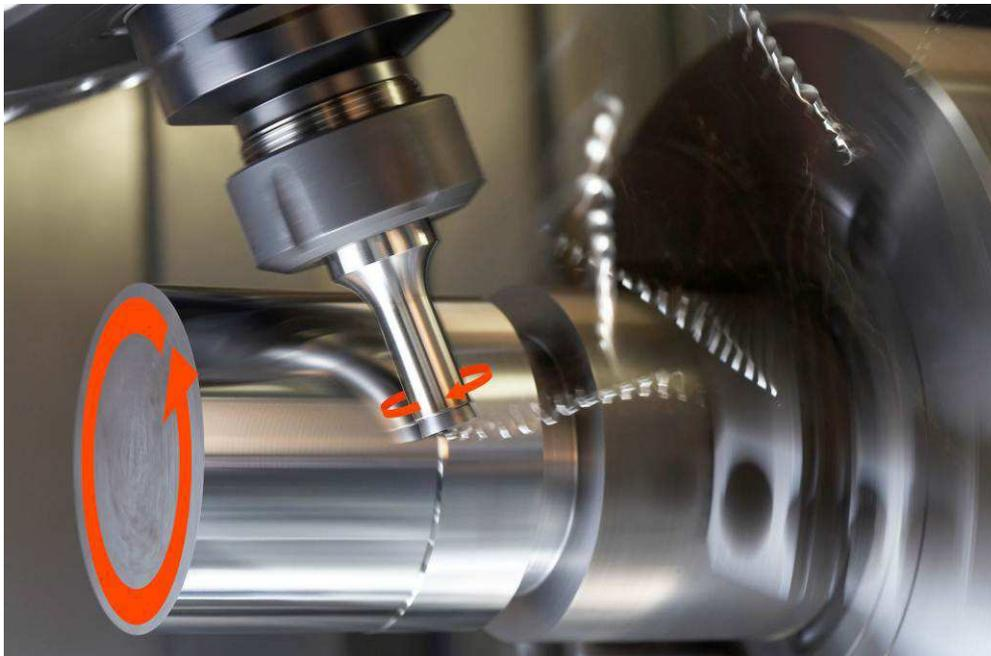
図.8 スピニングツールによる加工
