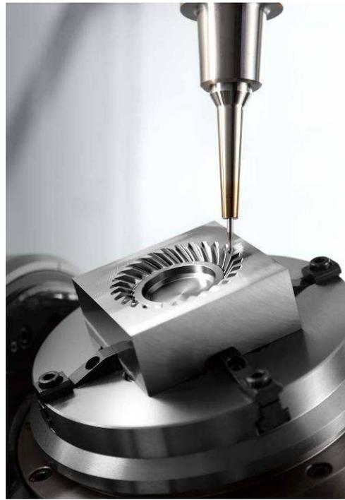
図.11 ベベルギヤ鍛造型の加工
