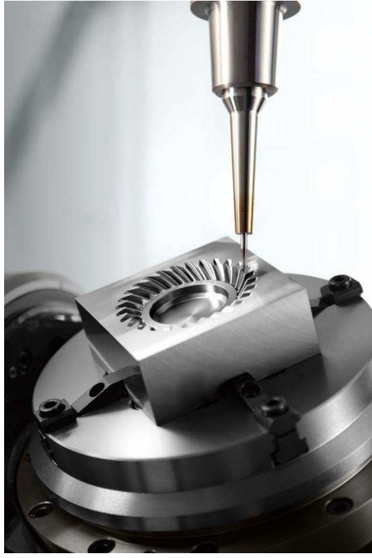
図 5. ベベルギヤ鍛造型の加工 (NVX5080/40 + 5AX-DDRT200)
