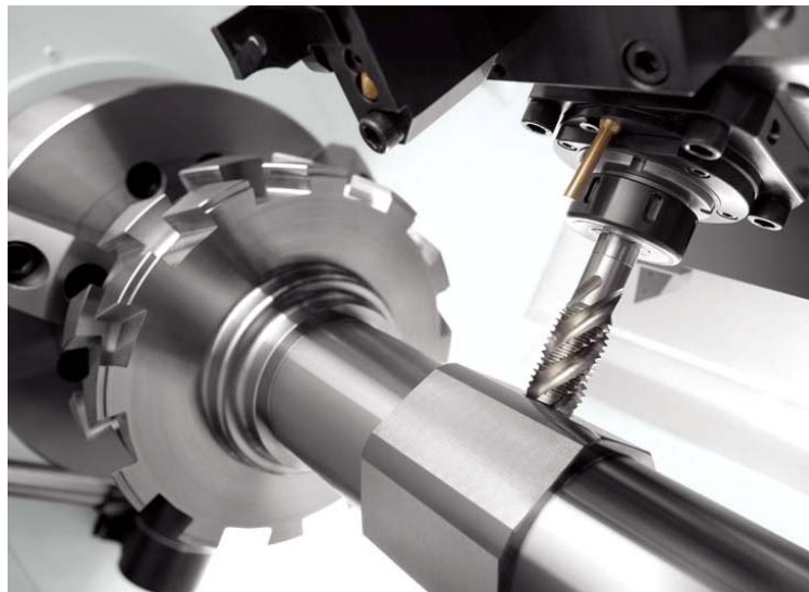
写真 2. 高トルクミーリング主軸での重切削
