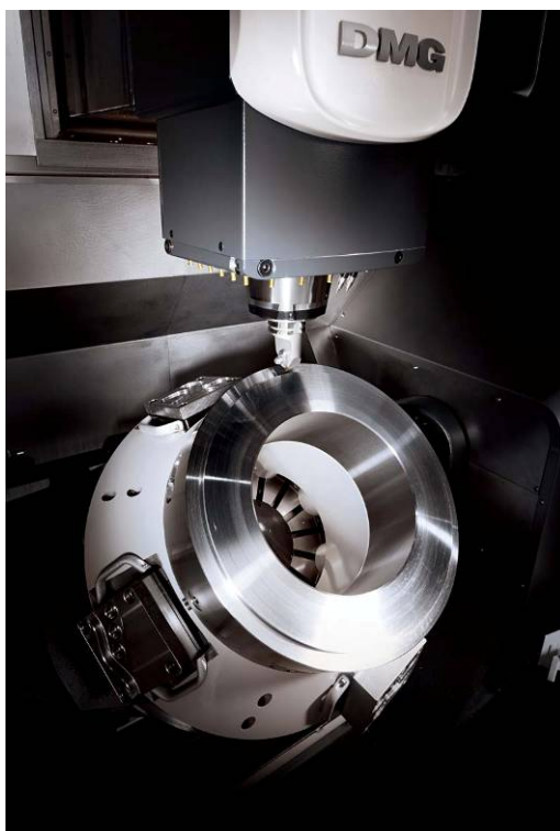
写真 6. FD 仕様での旋削加工
