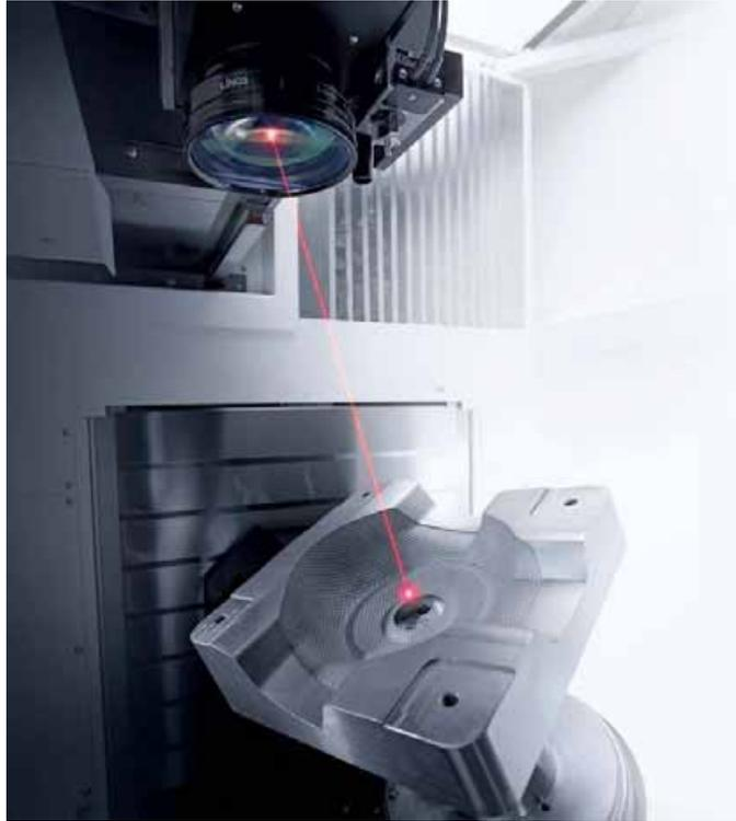
図 3. レーザによる自動車ハンドル金型のシボ加工
