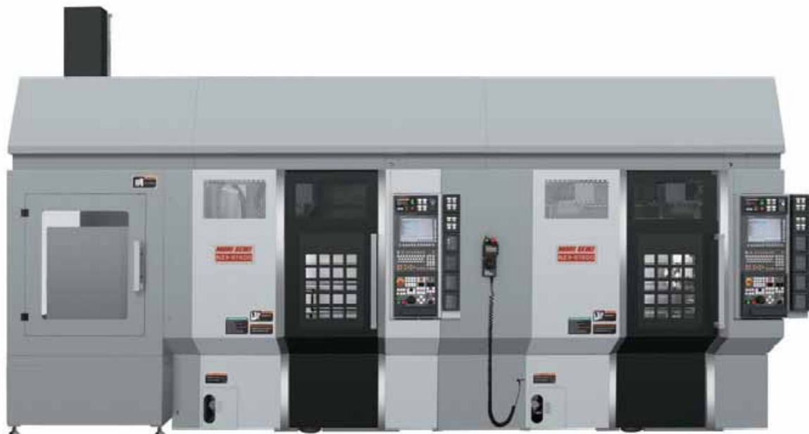
図 2. ローダシステム機外観 (2 台連結仕様)
