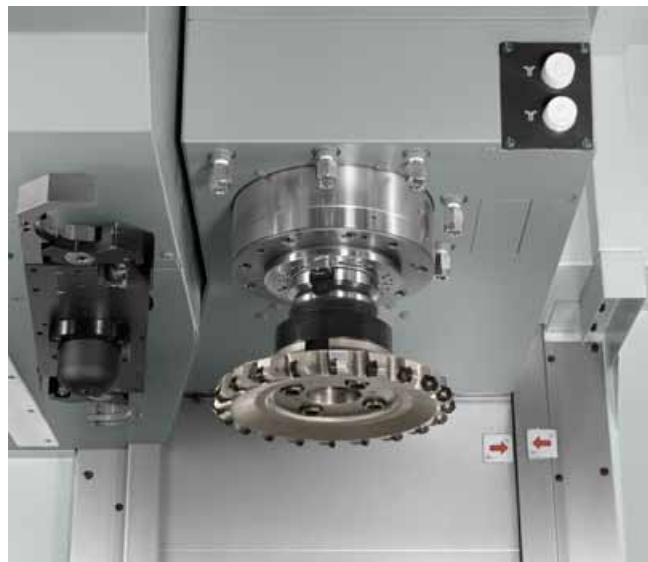
写真 2. 50 番テーパ主軸 ( \phi 240 mm フェースミル装着)
