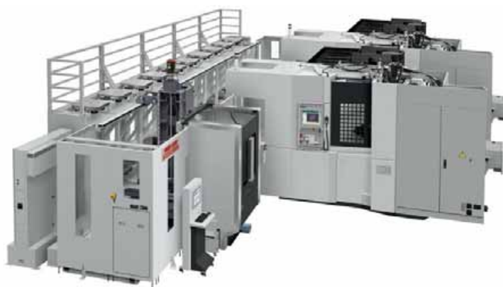
図 1. LPP(リニアパレットプールシステム)
