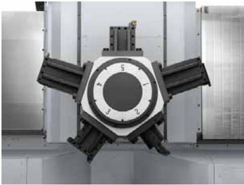
図 2. 刃物台ホルダ交換位置(NVL1350T)
