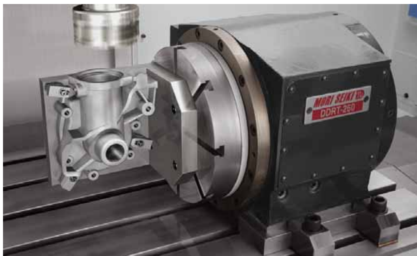
図 1. 加工事例(ウォーターポンプ)
