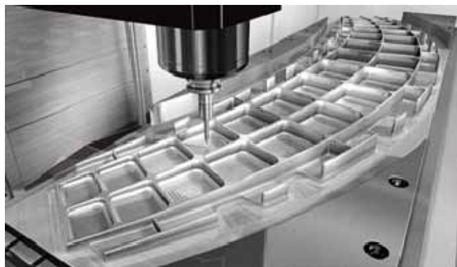
图 4. 加工事例(航空機部品)
