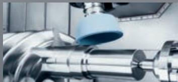
複数台で分割していたターニング及びミーリング加工のほか、専用機によるギヤ加工や完成ワークの計測などを1台に集約
