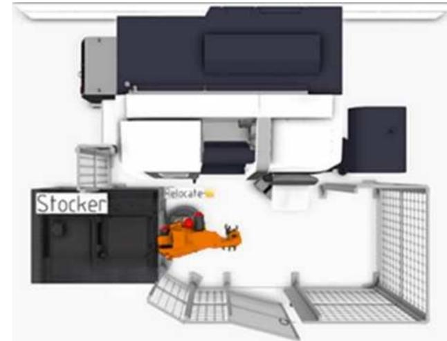
ビジョンセンサー搭載 自動ローディングシステム
