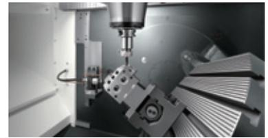
旋回軸2軸を任意の角度に位置決めし、直線軸3軸で加工する
