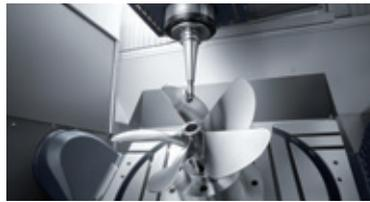
直線軸3軸と旋回軸2軸を同時に動かし、3次元曲面を加工する
