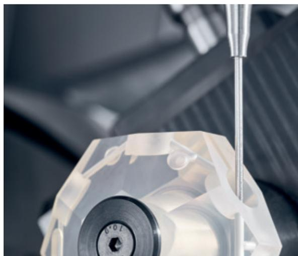
超音波加工は、セラミック、ガラス、コランダム、タングステンカーバイド、超硬合金、繊維強化材料など、一般的に加工が難しいとされる先端素材を複雑な形状へ効率的に加工することができ、近年は半導体関連の受注が増加しています。DMG MORIでは、工具を回転させながらZ軸方向に超音波振動を加えることで、従来の機械加工に比べて加工抵抗を最大40%抑制し、優れた面品位、加工精度、工具寿命の長期化を実現します。医療 / 歯科分野に適する、所要床面積がわずか3.5㎡のコンパクトマシンULTRASONIC 20等、製品ラインアップを充実させています。
