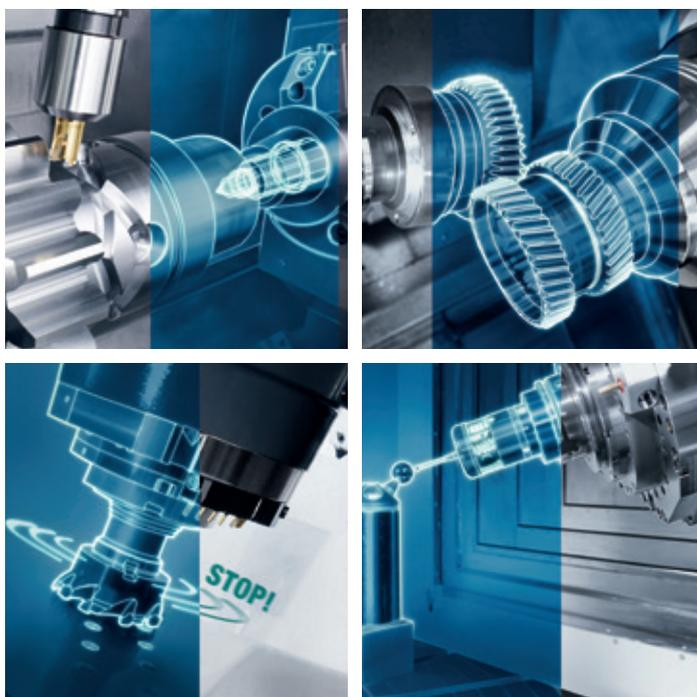
テクノロジーサイクルは、複雑な加工を簡単かつ短時間で実現するソリューションです。5軸加工機、複合加工機等の機械本体とロボット、切削工具、計測機器などの周辺機器、CELOS等のHMI (Human Machine Interface)を組込ソフトウェアで融合させます。これまで専用機や専用プログラム、特殊な工具で行っていた段取り・加工・計測を、汎用的な工作機械や標準的な工具・治具等で、誰もが簡単かつ短時間で、高い品質を実現することができます。テクノロジーサイクルは、ハンドリングサイクル、切削サイクル、計測サイクル、モニタリングサイクルの4つの機能に区分され、現在グループで計43種類を提供しています。
