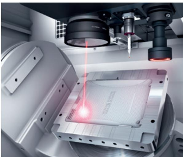
レーザ加工はレーザビームを加工素材に照射し、工具等を素材に接触させることなく切断、彫刻、マーキング等を行う技術です。DMG MORIのLASERTECシリーズでは、加工特性の異なるYAG、ファイバー、フェムト秒等のレーザソースを選択できます。3Dレーザ除去加工は射出成形用金型やプレス金型への幾何学的な表面模様の仕上げ加工、複雑なポケット加工、微細な型掘り加工、マーキング、レタリングが可能です。5軸レーザ精密切断加工は精密部品の製作に、5軸レーザドリル加工はガスタービン部品の冷却孔の穿孔等で使用されています。また、従来の加工方法が限界に達しつつあるダイヤモンド加工において、消耗材料を必要としないグリーンテクノロジーを実現しています。
