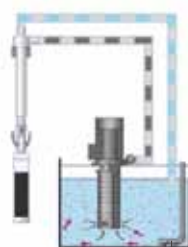
スラッジ攪拌ノズル
