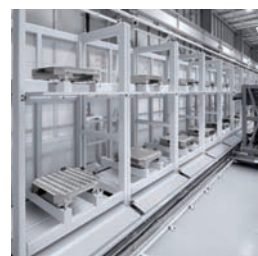
MH-1003 LPPシステム：パレット棚2段で総棚数は24枚
