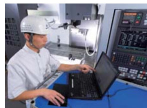
レーザー測定器による位置決め繰り返し精度検査
