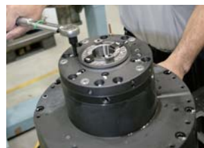
セル生産による主軸ユニットの組立
