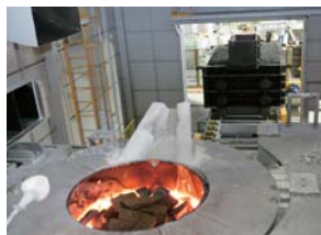
集塵等、環境に対応した自動化ライン
