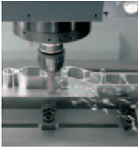
加工方法を分類すると、主に付加加工、変形加工、除去加工に大別できます。森精機は、金属材料や樹脂材料を除去加工するための工作機械を製作しています。
