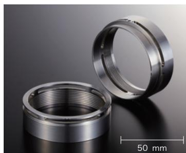
ワンチャッキングで、裏側の端面・面取りも一工程で行っている。ステンレス材で無垢からの薄物加工になるため、どうしてもひずみが出てしまうところを、切り離しの際の条件を工夫することで、同軸度0.01以内を実現している。
