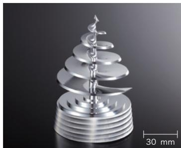
先端と外周部分はビビリやすいので最初に加工し、徐々に根元を切り込むようにプログラムを組んだ。切り込んで行く際のカッターマークが残らないようにアプローチ方法を工夫した。
