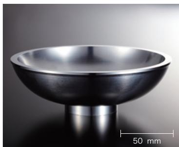
立形マシニングセンタでの2.5軸加工。実物大の大きさの為、切削抵抗とクランプ力との兼ね合いに苦労した。
