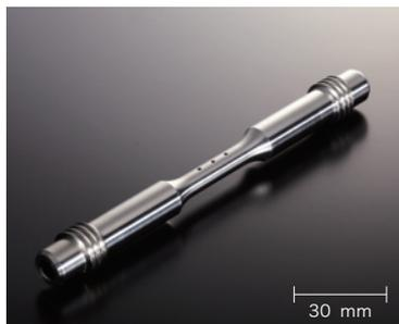
中空平行部冷却タイプの疲労試験片で、原子力や航空機で使用される中空タービンブレードを想定したもので、試験片内部を中空にして平行部を0.5 mmの薄肉加工、その後1 mmの穴を3箇所貫通させている。
