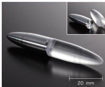
2軸旋盤で、座標点群を繋げて亚克力、アルミともにダイヤで楕円形状に削った。楕円形状の反対側の端面に溝加工を施し、ピッタリはまるように溝の凸凹を非対称で作製した。この溝加工の為に独自に刃物を作成し改良した。
