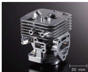
同時5軸加工によるワンチャッキング加工。量産型前の試作品の為、小径刃物による深彫り加工。
