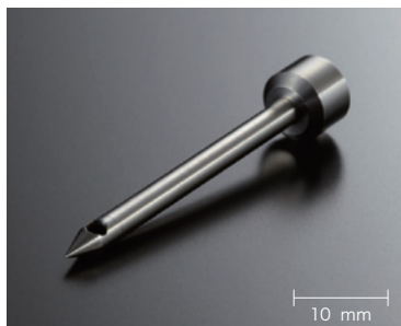
材 質：SUS304 加工機械：スイス型自動盤 加工時間：1個 1分53秒
