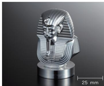
頸のコブラ、ハゲ鷹は切削速度に注意して加工を行った。最小工具を超硬ボールエンドミルR0.5 mmとし、どこまで形状を表現できるか試してみた。顎の突起部分と胸の部分は6、7面方向を定義して角度を与え、干渉させずに加工することができた。
