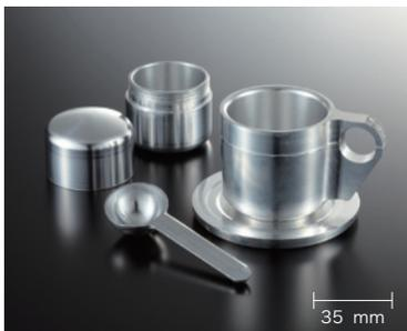
CAD/CAMを使用せずに、NCカスタムマクロプログラムのみで制作した。加工能力と面性状の向上を図るため、全ての加工にうず巻き加工のマクロプログラムを開発し加工した。
