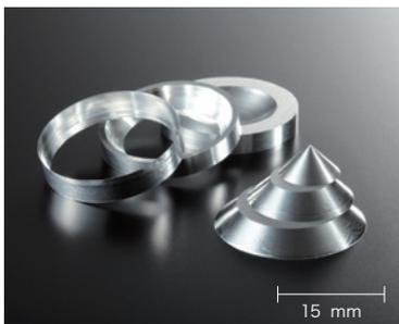
この立体は、球の体積が $4\pi r^3/3$ であることや、半径・高さの同じ円柱・球・円錐の体積比が3:2:1になることを理解するための「数学の理論を体感する」教材である。3枚のスライスを一体で加工するために板を重ねて接着し加工している。
