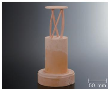
工具姿勢の修正方向を、曲円柱の週方向と軸方向に限定することで、計算時間の短縮と工具姿勢の連続性の確保を実現した。工具の決定から、NCの出力まで一連の処理は全て、独自に開発した巧妙加工用CAMシステムにより自動で行った。
