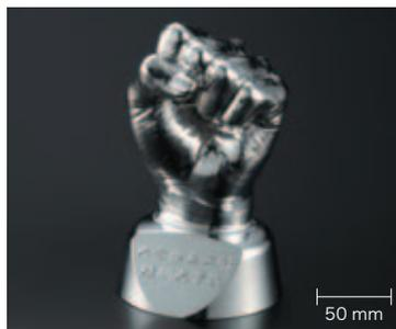
レーザースキャナで形状データを取り、他方向からスキャンした形状のサーフェスデータを合成する際に形状のイメージを壊さないように注意した。加工では同時5軸加工を取り入れ、より精度の高い形状製作を目指した。また拳の質感を損なわないCLデータの製作に終始した。
