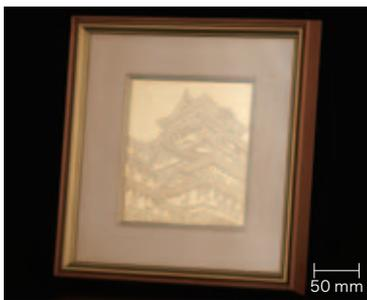
ダイヤ面の空間色で4D画像の彫金画 (姫路城) である。デジタルカメラの画像を基に、CADでダイヤ面の空間色にしたり、4D画像に作図した。そのNCデータを使用し、ボールエンドミルで彫り込むだけで、黄銅板の表面の色を純金にしたり、4D画像にしている。
