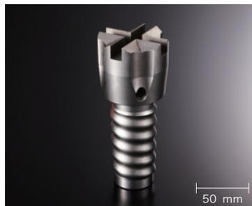
サイズ等の種類が多い接続部のねじ形状を、総型バイトを使用せずにマクロプログラムを駆使し、微いバイトで仕上げている。掘削時の衝撃や環境に対して「ねじ接合が容易」「かじりにくい」「強度が増す」などの特長がある。
