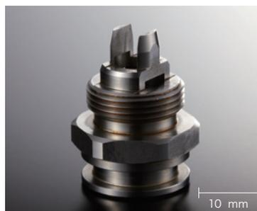
先端部の変形をおさえる為、ミーリングと旋盤の加工順序を工夫した。
