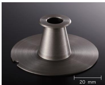
丸棒からの削り出し。薄肉(1 mm)ワークである為、ビビリや歪みが発生しやすく、加工条件を探し出したり、切れ刃部の状態調整がポイント。刃具の状態により、毎回同条件で加工が可能とは限らない。
