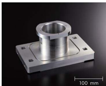
3工程にて加工。端面の幅3 mmの溝加工は工具の突出しが長く、切削条件の設定に苦労した。
