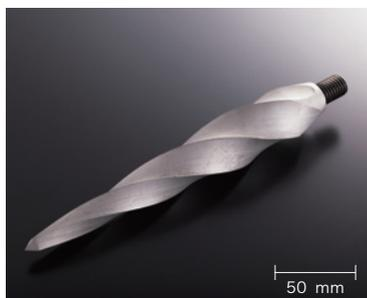
Y軸を用いた高効率加工。先端のピラミッド形状の加工時のクランプ方法は、専用の治具を製作して、効率よく加工。
