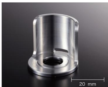
バー材からの削り出し加工。加工段差が最小になるようにしている。
