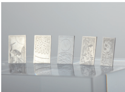
材 質：STAVAX HRC54 加工機械：立形マシニングセンタ、彫刻機 加工時間：1個 約4時間35分
