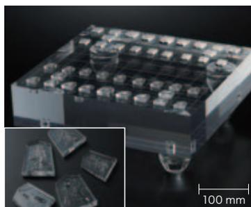
文字から3次元モデリングをし、特殊工具で透明度を出しながら切削加工している。切削加工後に磨きをかけていないので、製品の文字・形状がくっきりと出ている。
