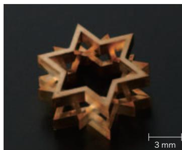
直径10.0 mm×1.5 mm肉厚0.5 mmの星を3個重ね一体型にした。全ての内コーナーエッジをゼロRのピン角にしている。特に工夫したのは二段目の鋭角の内コーナー加工の時、鋭角なため切粉が掃けず刃物欠損が頻繁に起こった。微径刃物の製作にも苦労した。
