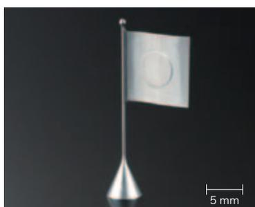
支柱はφ0.5 mm、旗は大きさ10×10 mm、厚さ0.1 mmとし、風で揺れている感じを表現した。中央部にφ5 mmで0.05 mmの凹凸を加えたモデルを作成し、角材からの削り出し加工に挑戦。工夫した点は高速・高精度に加工できるクランプ方法である。
