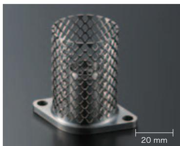
複合加工機でどこまで深く加工出来るか。ハニカム形状もきれいに加工出来る様に5軸マシニングセンタで割出し、仕上にφ1.5エンドミルを使用。ハニカム形状(アミ目部分)のR値を小さく加工する事を重視し製作した。
