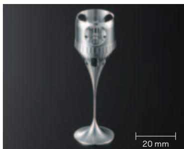
最も細い柄の部分はφ1 mmを実現している。カップ内の首部の小径の窓はカップ外側の窓から加工したが、その他の首部の加工は2方向側（スタンド上面側）から加工している。カップ部側面には36角形の加工を行った。Rに沿っての溝加工がポイントである。
