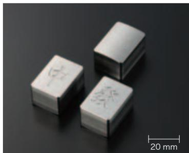
難削材への微細加工。最小工具はR0.3 mmのボールエンドミルで文字彫りを行った。また、忠実に表現したR加工。更に職人の技術に頼らないオール機械加工を実現。背中の曲面部も加工している。
