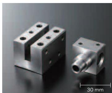
従来は立形マシニングセンタ加工で1面ずつ加工していたものを、NL2000Y・2方爪で同時2面加工にて加工し、工程数の削減。
