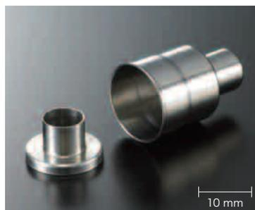
φ16 mm×25 mmの無垢材よりの削り出し加工にて、肉厚0.4 mm±0.05 mm均一形状を歪無しにて旋削工程を2工程にて行う。肉薄加工につき、チャッキング及び切削条件に対し、ノウハウが必要。
