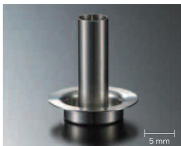
薄物加工において、内径・外径の要求精度に対し、0.01 mm以内の精度にて加工。また、端面振れ0.01 mm、加工精度0.01 mm以内を達成。
