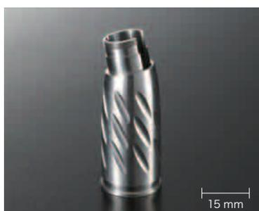
複合加工機で製品の削り出し加工をしている。第1主軸から第2主軸に受渡し、全ての加工が完了。(ねじ切り、バリ取り含む)
