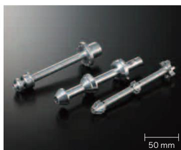
丸棒材からの削り出し。複合(Y軸)旋盤での工程集約。
