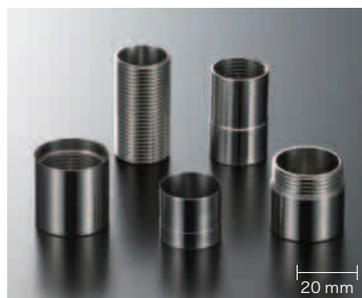
薄肉加工部品5点の組み合わせで、全ての部品が肉厚0.1~0.2 mm。(ねじ部は谷部からの肉厚が0.2 mm)
