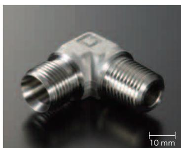
3つ爪で爪の段取り換えなしで1-2工程加工できるように工夫した。標準の3つ爪チャックで爪段取り換えなしで加工できることがポイント。
