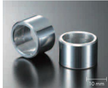
外径±0.002 mm、内径±0.001 mm、内径溝深さ±0.002 mm、溝角度25°が、対称にターンしている。また、真円度及び同心度も0.002 mm以下。表面粗さ0.85。
