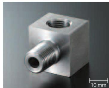
内径ねじR1/4をタップ加工よりNCL加工にする。市販(タンガロイ)チップでは、そのまま使用できないため、手研ぎで使用。切くずを後方へ出すよう、また寿命を長くするように研ぐのが難しい所。
