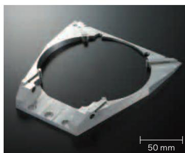
10数年前に作っていた部品で、当時は5軸加工機が出ていない時代で、角度を付けて加工するのが大変であった。
