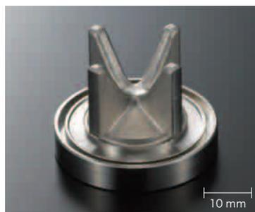
SUS304系ロストワックス鋳物で安全弁の主要な部品である。安全弁の作動時にガイド部になる部分が断続切削で要求精度があり、かつ長時間の工具寿命 (加工数/刀) 200個を可能とした。
