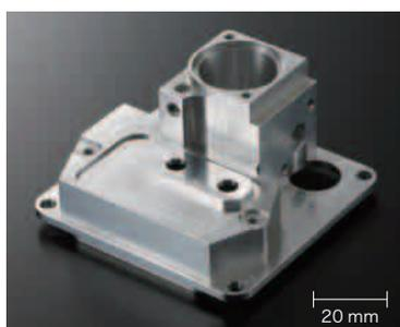
エンドミルによる正確な溝加工と、正確な段取りによる各面の穴あけ、タッピング加工がポイント。穴に合わせて加工したフタも重要なポイント。
