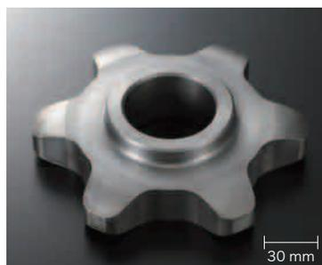
刃の加工にて、1刃当り円弧とテーパ部の組み合わせが20点以上有り、繋ぎ目がわからないようプログラム加工をしている。
