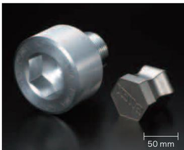
ヘキサゴンレンチのボールポイント部を使って、KOWAのロゴのハンコを作成。そのハンコ置き場としてM64×P4のビスも加工し、セットで出品。
