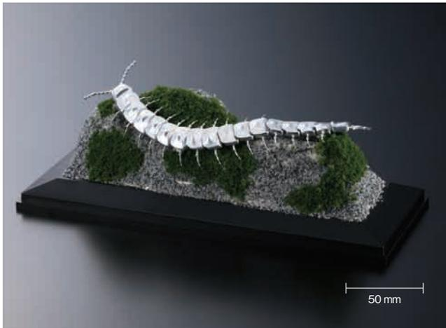
百足をモデリングし、17体を高精度仕上げに加工し、2球状ボールにて連結させたアルミ切削加工。足のつま先には小径エンドミルにて微細なバンプ形状を取り入れられた加工が施されている。
