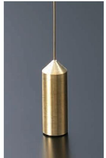
主軸回転を上げるとすぐに曲がる強度の無い素材をチャックのみでクランプし、小径に加工した作品です。外径に旋削の継ぎ目もなく仕上がっています。
