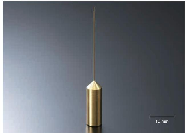
主軸回転を上げるとすぐに曲がる強度の無い素材をチャックのみでクランプし、小径に加工。外径に旋削の継ぎ目も無い。
