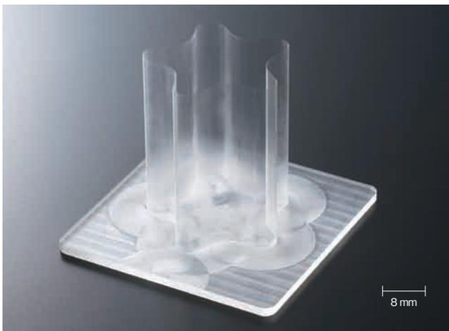
欠けやすいアクリル材で切削条件や形状を工夫し肉厚0.05 mm、高さ38 mmの切削加工を実現。
