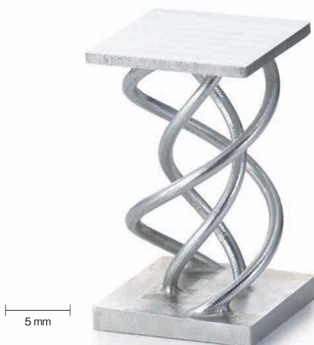
$\phi 1\text{ mm}$  (有効長12 mm) のボールエンドミル加工です。加工物のひずみや変形を抑えるための、加工パス手順の考案や、治具の作製がポイントです。
