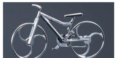
基本フレーム、タイヤ径は $\phi 0.2$  mm、チェーンは $\phi 0.06$  mm。さらにフレームには $\phi 0.03$  mmで文字を彫ってあります。5軸機ではなく、3軸マシニングセンタによる加工である点もポイントです。
