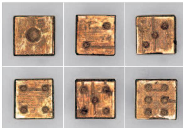
ポイントは0.008 mmの面取り、R0.03 mmの数字の目の部分の掘り込み部。機械加工での限界領域を拡大した。
