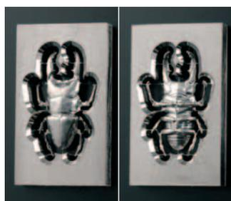
クワガタの模型をスキャンし、3次元CADで高精度な3次元データを作成。3次元CAMでNCデータ化し、高速マシニングセンタで加工する。
