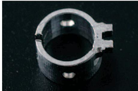
φ 2.4 mmの大きさの各方向に加工があり、全て公差がある。加工方法、工程数も増えるが、無くさず、つぶさず、精度を出すためには通常加工の集大成とも考えられる。
