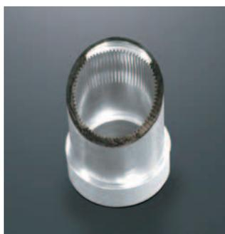
モジュール0.3、歯数72を複合機でシェーパー加工し、旋削部との同軸を最小としました (同時加工)。
