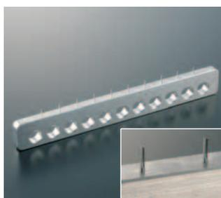
φ 0.7 mmピン削り出し後、0.25 mmスリ割り加工 (ワイヤーカット)。
