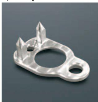
難削材の微細加工。スパイク部外径10 μm。ワークのクランプ方法が難しい。
